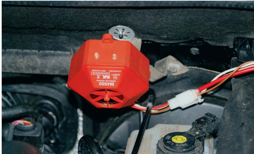
**Herz der Anlage:** Das Steuergerät beherbergt neben dem Hochspannungsteil, das die Kontaktplatten mit 200 bis 300 V beaufschlagt, auch noch die Ultraschallquelle und die Leuchtdioden zur Funktionskontrolle. Bild: Mareis
